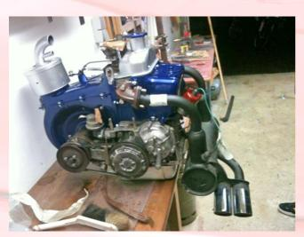
Der Motor wurde in alle Einzelteile zerlegt und komplett neu aufgebaut. Neue Verschleißteile, Zylinder, Laufbuchsen, Steuerkette und der Auspuff wurden eingebaut. Zu guter Letzt bekamen die Motorbleche auch noch einen neuen Anstrich.
