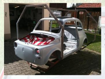
Im Anschluss drehten wir den Fiat auf den Kopf um uns den abschließenden Unterbodenarbeiten widmen zu können. Zuerst dichteten wir die Schweißnähte und die Fugen ab.
