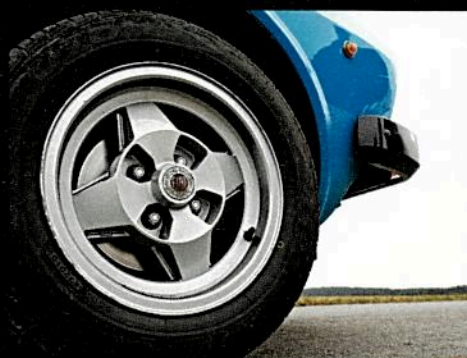
Statt der serienmäßigen dürrtigen Bereifung hat dieser Fiat BWA-Leichtmetallfelgen 6.0 x 13 und 185er-Reifen
